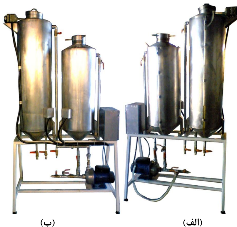
شکل ۱: الف- نمای پشت ب- نمای مقابل دستگاه فرآوری بیودیزل
